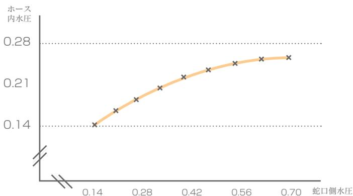
当社の圧力調節器は水量を犠牲にすることなく、最適な圧力に調節します。ホース全長ホース末端でも水がにじみ出る状態からの水のにじみ出を約束します。また、蛇口を急に開け増したときの水量の増加に対しても、ホースに大きな負担をかけずにダメージを防止します。
